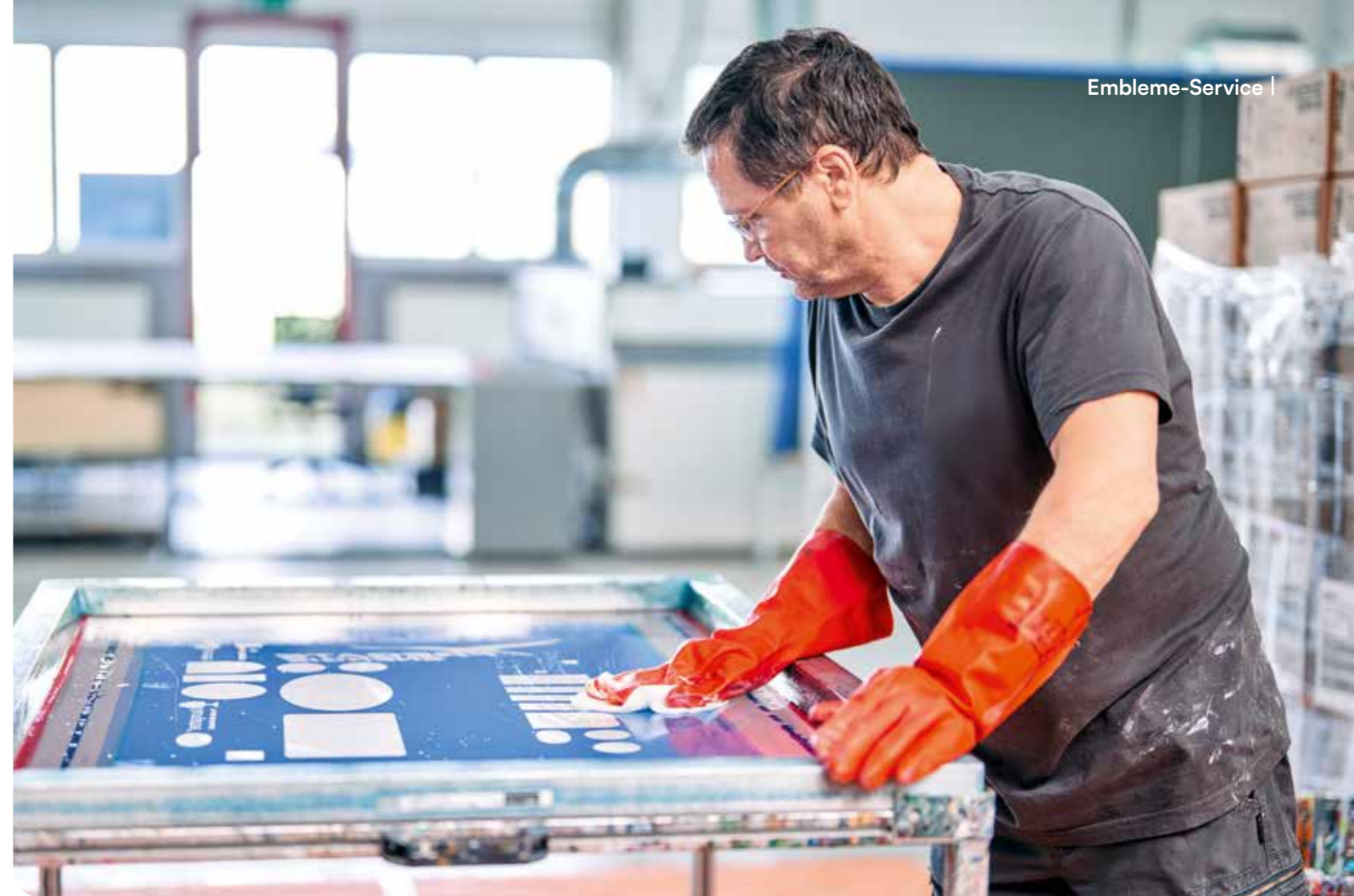
Vom Bildschirm auf das Sieb für den Siebdruck: Bei THERMOTEX kommt alles aus einer Hand
