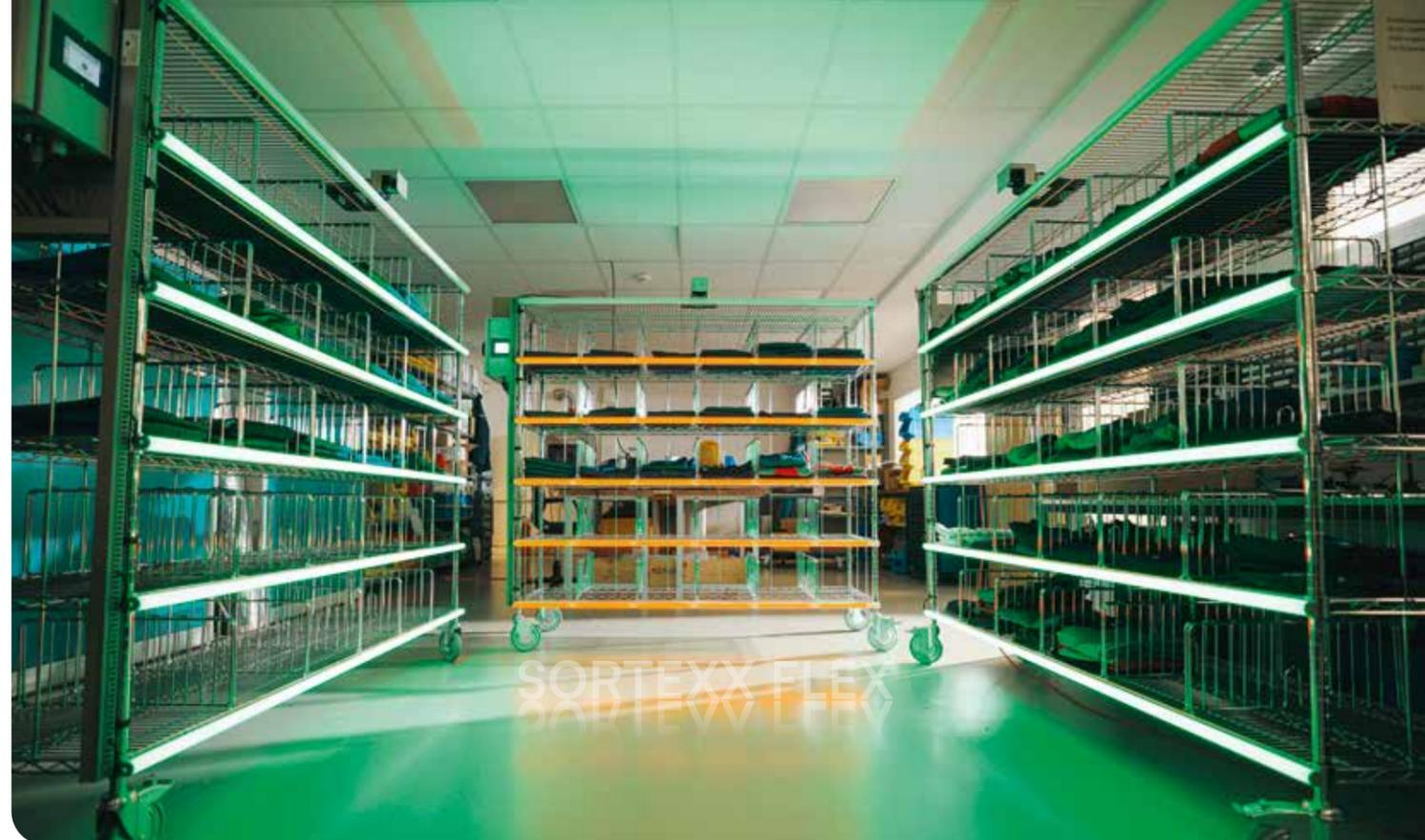
Voici comment cela fonctionne : une unité de capteur installée au-dessus des étagères contrôle à quel compartiment chaque vêtement doit être attribué et gère l'accès. Une lumière verte indique où les vêtements peuvent être déposés ou retirés.
