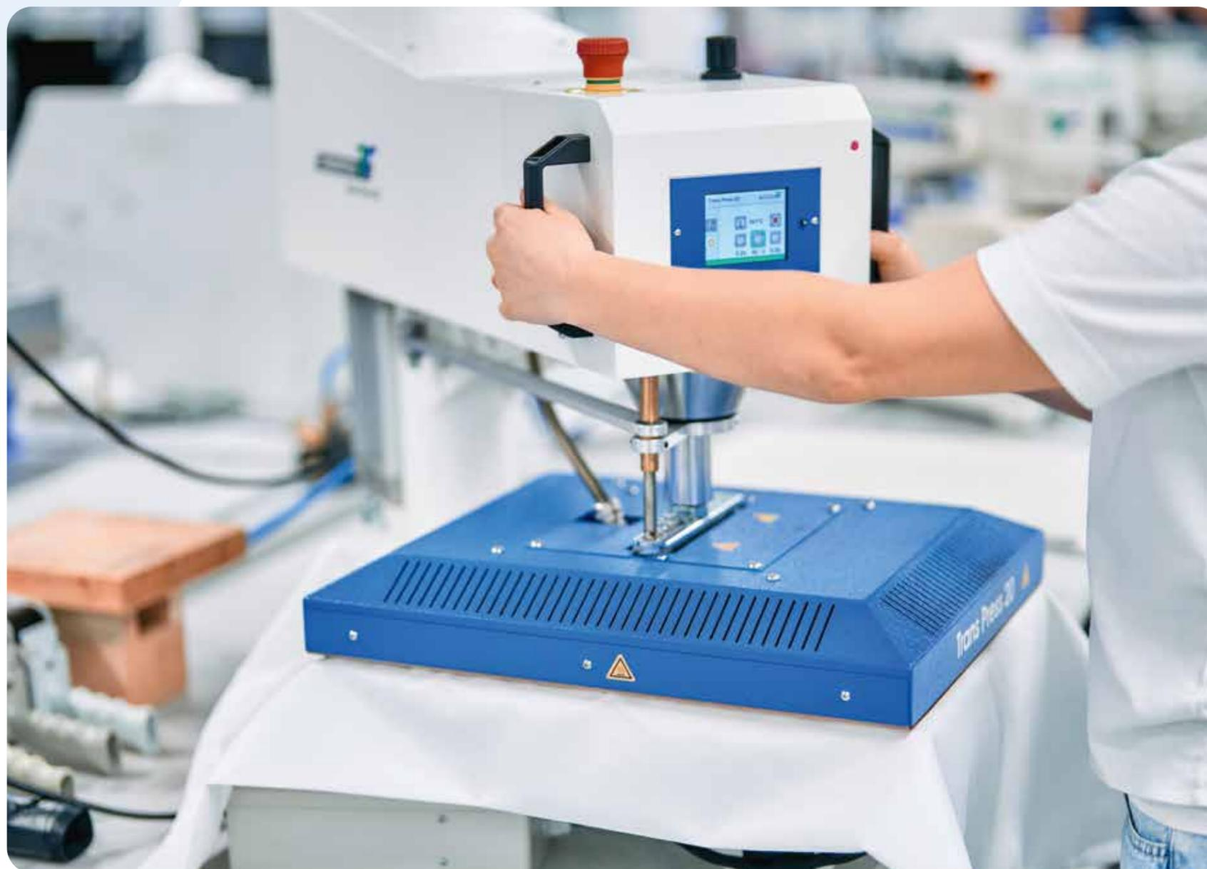
La bonne température, la bonne pression et le bon temps d'application — pour que tout fonctionne à la perfection, THERMOTEX utilise des presses à transfert de dernière génération. Mais lorsqu'il s'agit du contrôle qualité, rien ne remplace l'œil humain et l'expérience du terrain.
